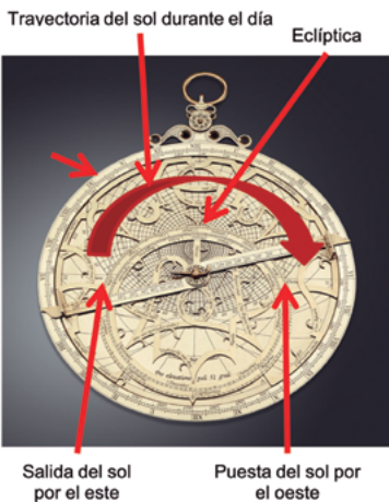
Figura 16. Movimiento del sol en un astrolabio
