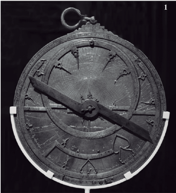
Figura 1. Astrolabios andalusíes. El nº 1 opera en 11 latitudes. El nº 2, trabaja en 5 latitudes
