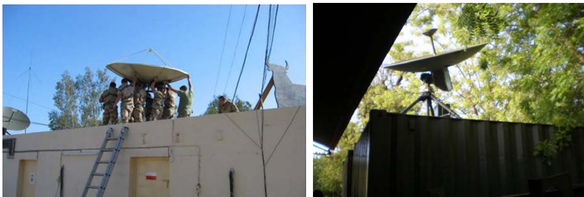
Figura 4. Terminal en Banda Ku en Afganistán, a la izquierda y Terminal en Banda X en Mali, a la derecha (Fotografías del área de Estudios y Proyectos de la Jefatura CIS del ET).
