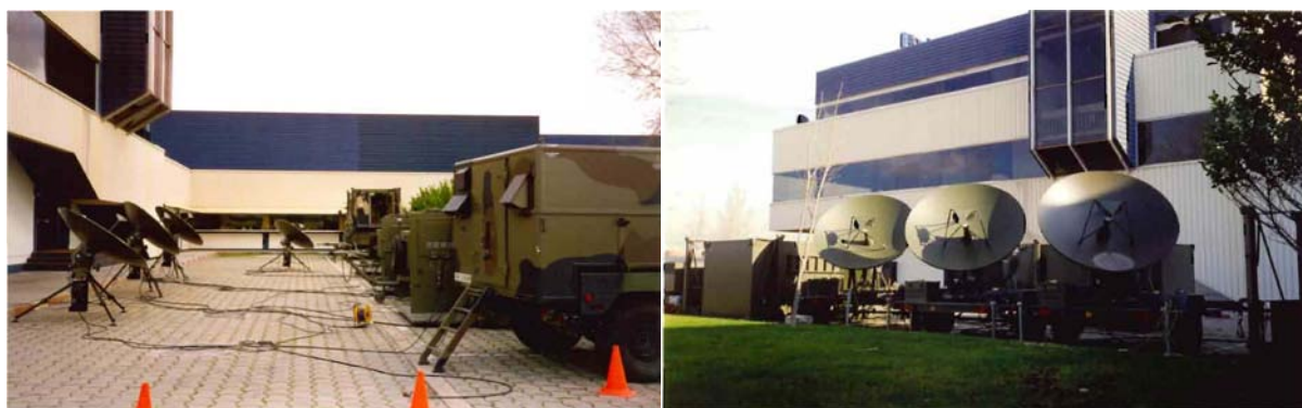
Figura 3. Terminales tácticos satélite (portadoras 128/256 kbps), a la izquierda y Terminales tácticos para la Red Digital Táctica en tareas de mantenimiento, a la derecha (Fotografías del autor).
